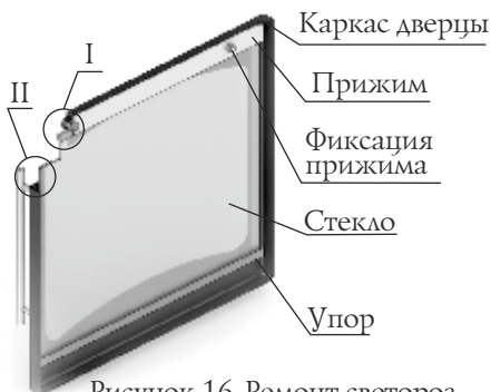
Рисунок 16. Ремонт светорозрачного экрана дверцы модели «Витра»
